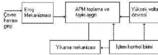
Piezoelektrik terazi yöntemi şeması
