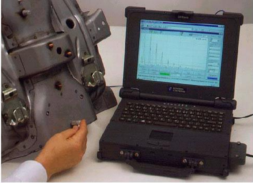
Şekil 11. Direnç kaynaklı parçanın hata tespiti
