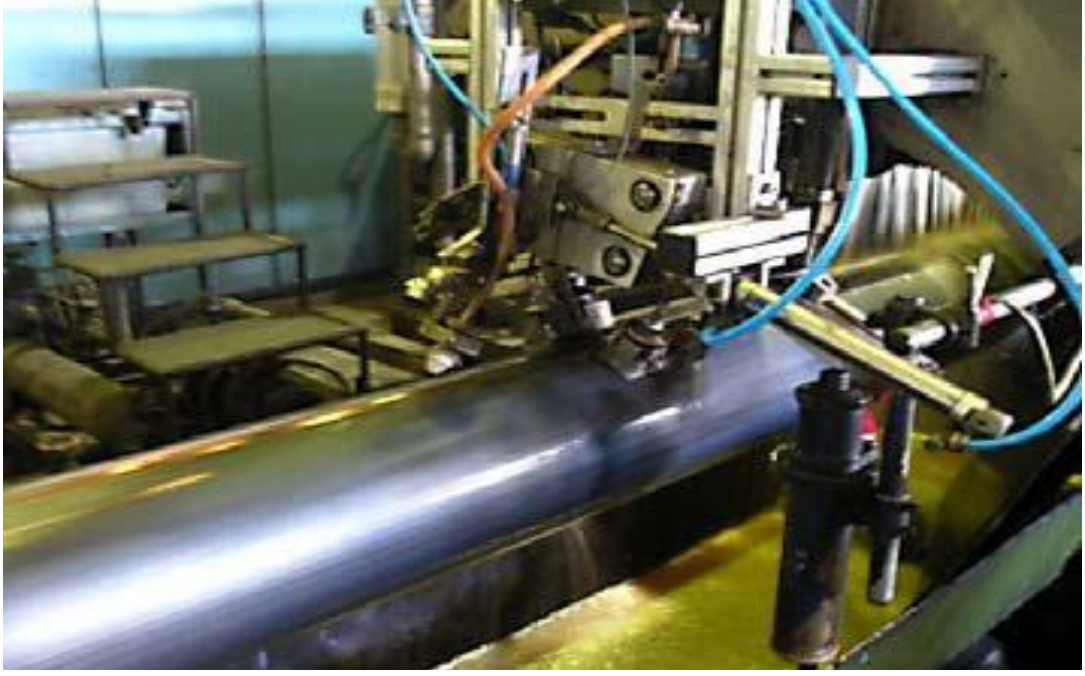
Şekil 9. Ultrasonik laminasyon cihazı ile boru kontrol
