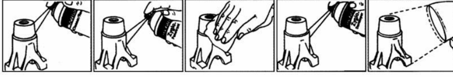
Şekil 6. Ultraviyole ışınları altında sıvı emdirerek yapılan muayenenin aşamaları
